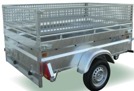
PTAC 500/600/650/750 kg, masse à vide 206 kg, dimensions utiles 203 x 134 x 50 cm, roues 155/70R13, résistance essieu 750 kg, 1 essieu, roue jockey Ø 48, Ridelles avant et arrière rabattables
